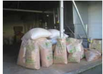
➤ Ensuite, les bouchons sont transformés, sans adjuvant chimique ni autre additif, en un fin **granulat de liège** conditionné en sacs de 100 litres prêts à l'expédition. Il sert à la fabrication de plaques d'isolation et, mélangé avec la paille et l'argile, de briques crues isolantes utilisées surtout pour la rénovation des maisons à colombage.
